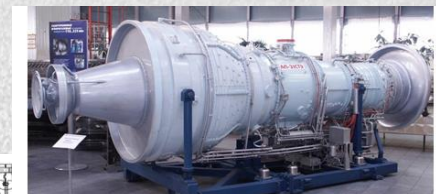
ГТУ АЛ-31СТ разработан ОКБ имени А. Льюльки по техническому заданию ОАО "Газпром"
