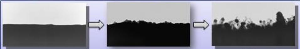
Установлено, что при нагреве массивного сплава на основе никеля в среде 1,2-дихлорэтана происходит его первичное диспергирование на частицы размером 0,25 мкм, отрывающиеся от поверхности растущими волокнами.
