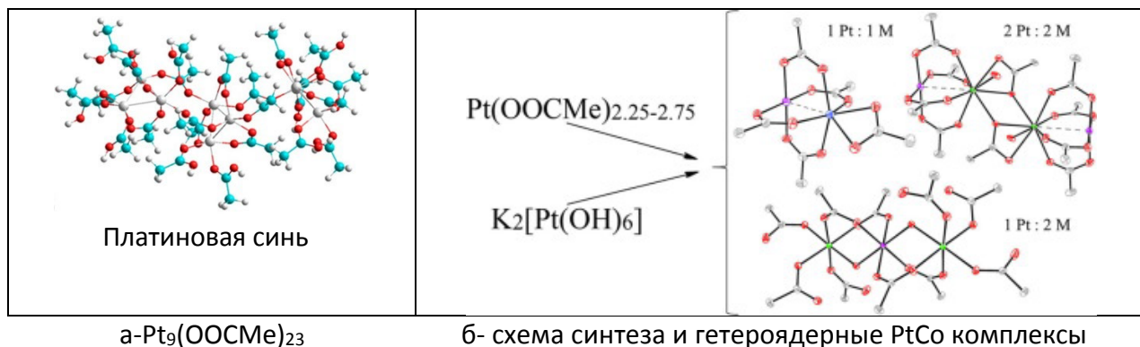
Рис. 1. Ацетатные комплексы платины как предшественники в синтезе катализаторов
