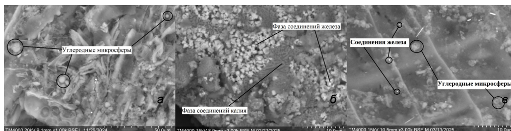
Рис. 1. Поверхность образца исходного гидроугля НС-230 (а); после пропитки \text{K}_3[\text{Fe}(\text{CN})_6] с последующей карбонизацией при 800^\circ\text{C} (б); после отмывки карбонизованного образца \text{HCl} (в).
