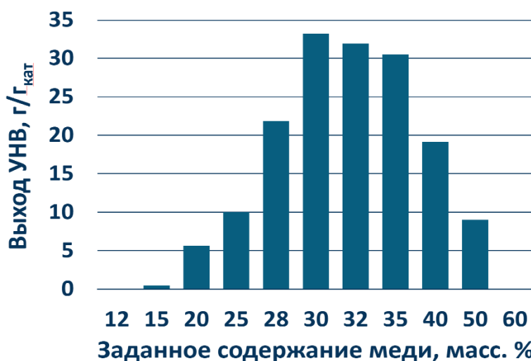
Рис. 2. Каталитическая активность (100-x)\text{Ni}-x\text{Cu} ( x = 5-50 об. %) образцов в процессе разложения \text{CH}_4/\text{H}_2 смеси при 650^\circ\text{C} за 60 минут
