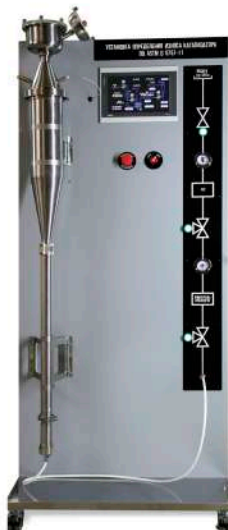
АВТОМАТИЗИРОВАННАЯ УСТАНОВКА ОПРЕДЕЛЕНИЯ ИЗНОСА КАТАЛИЗАТОРА ДЛЯ КРЕКИНГА С ПСЕВДООЖИЖЕННЫМ СЛОЕМ ВОЗДУШНОЙ СТРУЕЙ СОГЛАСНО ASTM D5757-11
