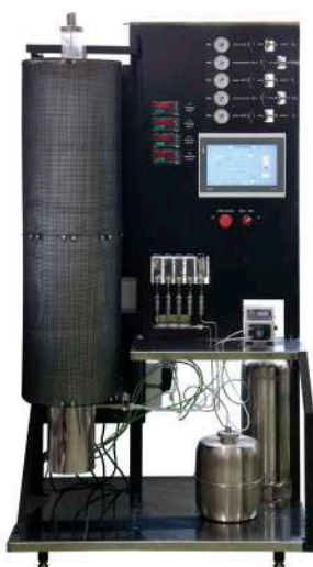
УСТАНОВКА ПРОПИЛЕНОВОЙ ПРОПАРКИ
