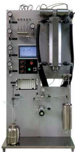
ПИЛОТНАЯ УСТАНОВКА ДЛЯ ПРОВЕДЕНИЯ КАТАЛИТИЧЕСКОЙ РЕАКЦИИ ОКИСЛЕНИЯ ПРОПИЛЕНА
