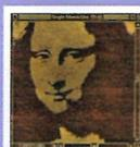
Анодно-окислительная литография на пленке Ti. Полуконтактный метод, размер скана: 8 x 8 мкм. Сверхпрочные зонды для нанолитографии
