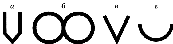
Рис. 9.1. Профили простейших элементов модельных пор, в которых происходит обратимая капиллярная конденсация.
