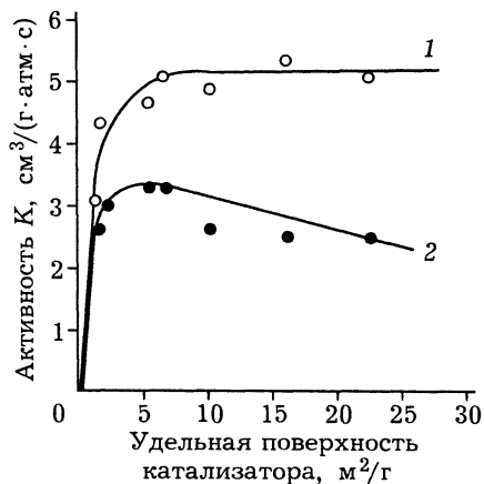
Рис. 12.10. Зависимость каталитической активности K ванадиевых катализаторов окисления \text{SO}_2 от величины доступной поверхности A_k : кривая 1 — для кинетической области (фракция 1—2 мм), кривая 2 — для диффузионной области (стандартные кольца 8 \times 8 \times 2,6 мм), по [11].
