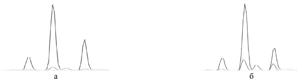
Рис. 2. Выход ионов m/z = 57 и 58 при крекинге сырья: а) не содержащего циклогексан- d_{12} , б) содержащего циклогексан- d_{12}
