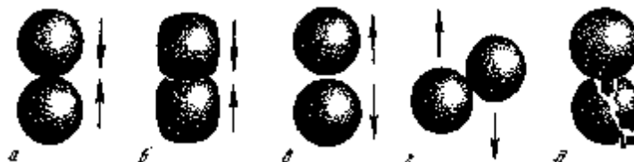
Рисунок 3 - Механизмы движения глобул при прессовании: без деформации (а), с деформацией (б), удаление частиц (в), скольжение (г) и разрушение (д).
