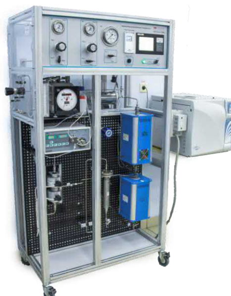
Рис. 1. Лабораторные установки: а – установка газификации углеродсодержащих материалов; б – установка получения синтетических углеводородов
