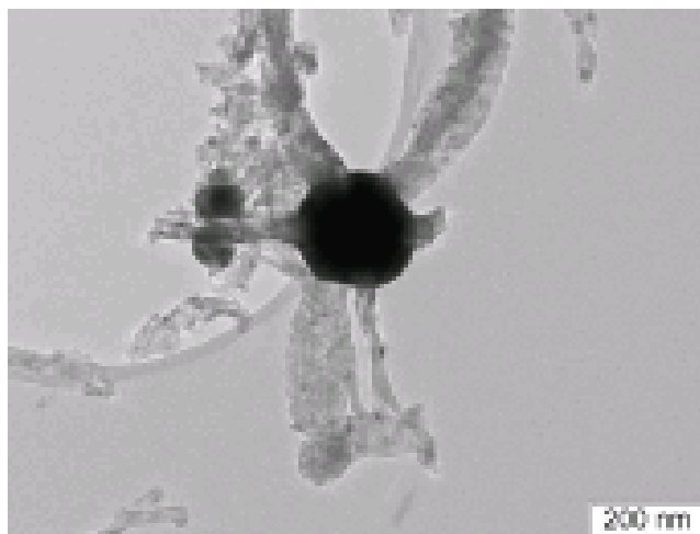
Рис. 1. ТЕМ снимок углеродных нанонитей, сформированных в процессе разложения метана на 70%Ni-10%Cu-10%Fe/Al 2 O 3 катализаторе при 700 °С.
