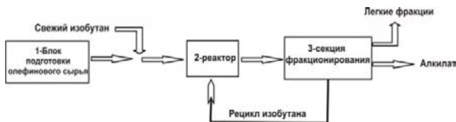
Рисунок 1. Функциональная схема установки алкилирования.
