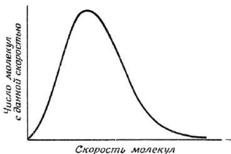
Рис. 6. Кривая, предсказанная Максвеллом и Больцманом, показывающая, какое число молекул имеет ту или иную скорость. Заметьте, что малые скорости имеет очень небольшое число молекул. Большая часть молекул имеет скорости, соответствующие участку кривой около максимума. Но число молекул с более высокими скоростями тоже велико. Среди них есть значительное число таких, скорость которых очень высока по сравнению со средней.
