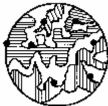
Рис. 6.10. Типичное строение гранулы гетерогенного катализатора. Заштрихованные области обозначают решетку твердого тела, светлые области — систему пор, черные точки — активные центры катализатора
