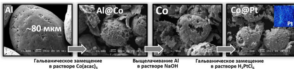
Рис. 1. Микрофотографии СЭМ исходного порошка алюминия, а также синтезированного на его основе кобальтовых и платино-кобальтового катализаторов.
