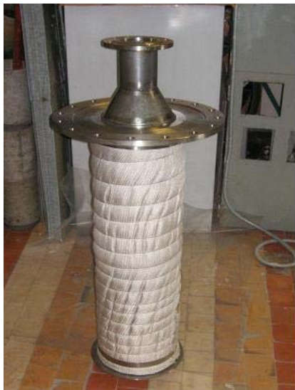
Рис. 1. Опорно-распределительное устройство реактора с радиальным слоем катализатора.
