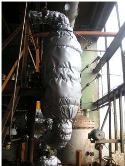
Рис. 2. Каталитический реактор в составе пилотной установки на площадке ВФ ИК СО РАН.
