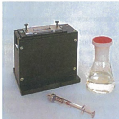
Приставка многократного нарушенного полного внутреннего отражения (МНПВО) для экспресс-анализа жидких и порошкообразных проб
