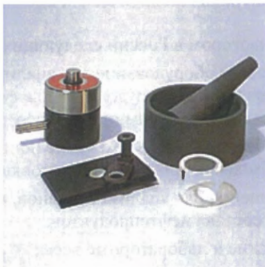
Ступка с пестиком, пресс-форма и держатель для приготовления и исследования проб твердых веществ, в виде таблеток из КВг
