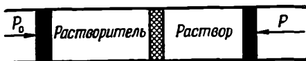
Р и с. 3. Соотношение между осмотическим давлением \Pi и внешними гидростатическими давлениями P и P_0 : \Pi = P - P_0 .
