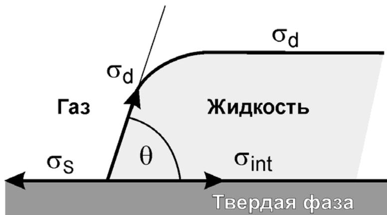
Рис. 2.3. Силы, действующие на границе соприкосновения трех фаз: твердой, жидкой и газа;  $\theta$  – «угол смачивания»
