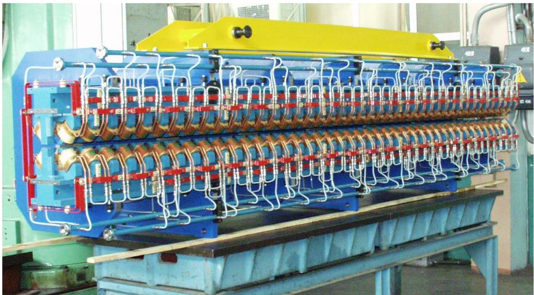
Рисунок 1. Эллиптический электромагнитный ондулятор UE212.
