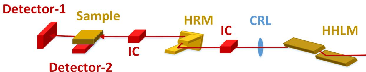
**Рисунок 3.** Схема экспериментальной установки для регистрации спектров NFS и NIS. Здесь IC – ионизационная камера для мониторинга пучка гамма-квантов, HRM – монохроматор высокого разрешения, CRL – составные преломляющие линзы или короткофокусные многослойные зеркала в геометрии Киркпатрика-Баеза, HHLM – монохроматор с высокой тепловой нагрузкой. Detector-1 – детектор для NFS, Detector-2 – для NIS.
