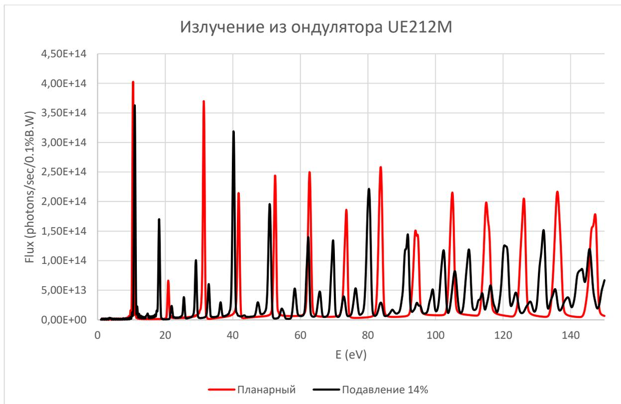
**Рисунок 6.** Спектры излучения из ондулятора UE212M на расстоянии 25 м от точки излучения в окне  $6 \times 6$  мм<sup>2</sup> в стандартном (планарном) режиме и режиме подавления высших гармоник.
