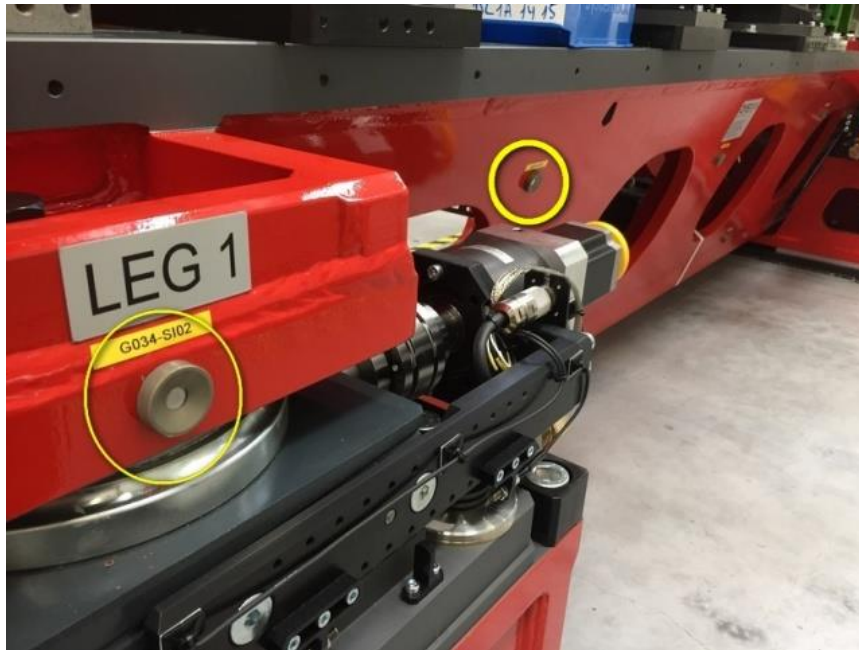
Рисунок 3.8.2. Геодезические знаки с магнитным держателем отражателя.
