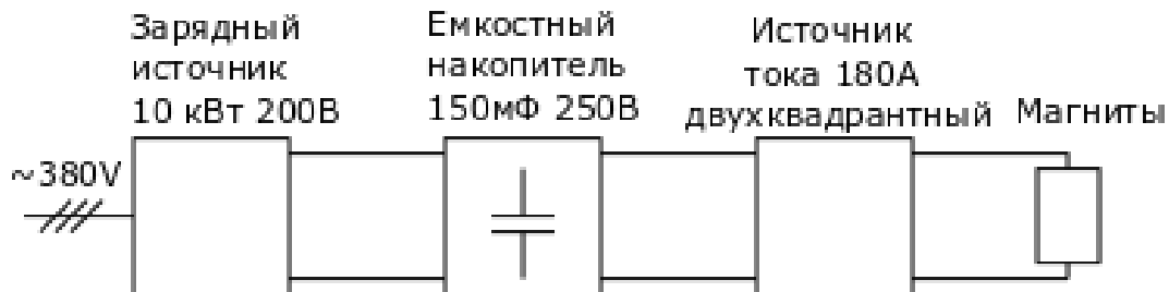
Рисунок 3.5.3.5. Структурная схема источника квадрупольных линз.
