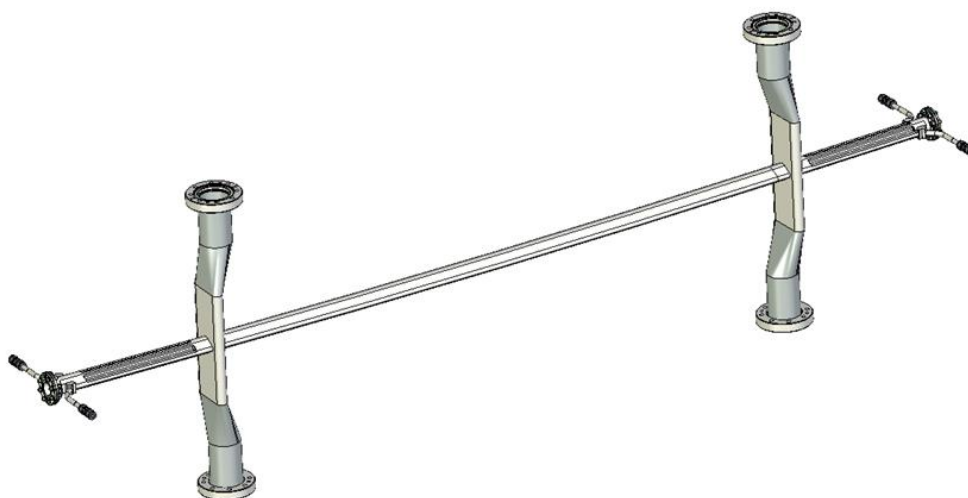
Рисунок 3.2.3.9. Вакуумная камера с малогабаритными вертикальными портами откачки.
