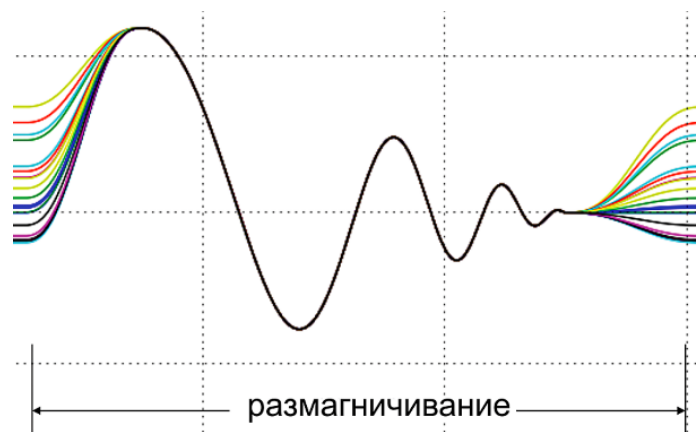
Рисунок 3.6.4.2. Пример размагничивания отдельных магнитов-корректоров орбиты пучка.
