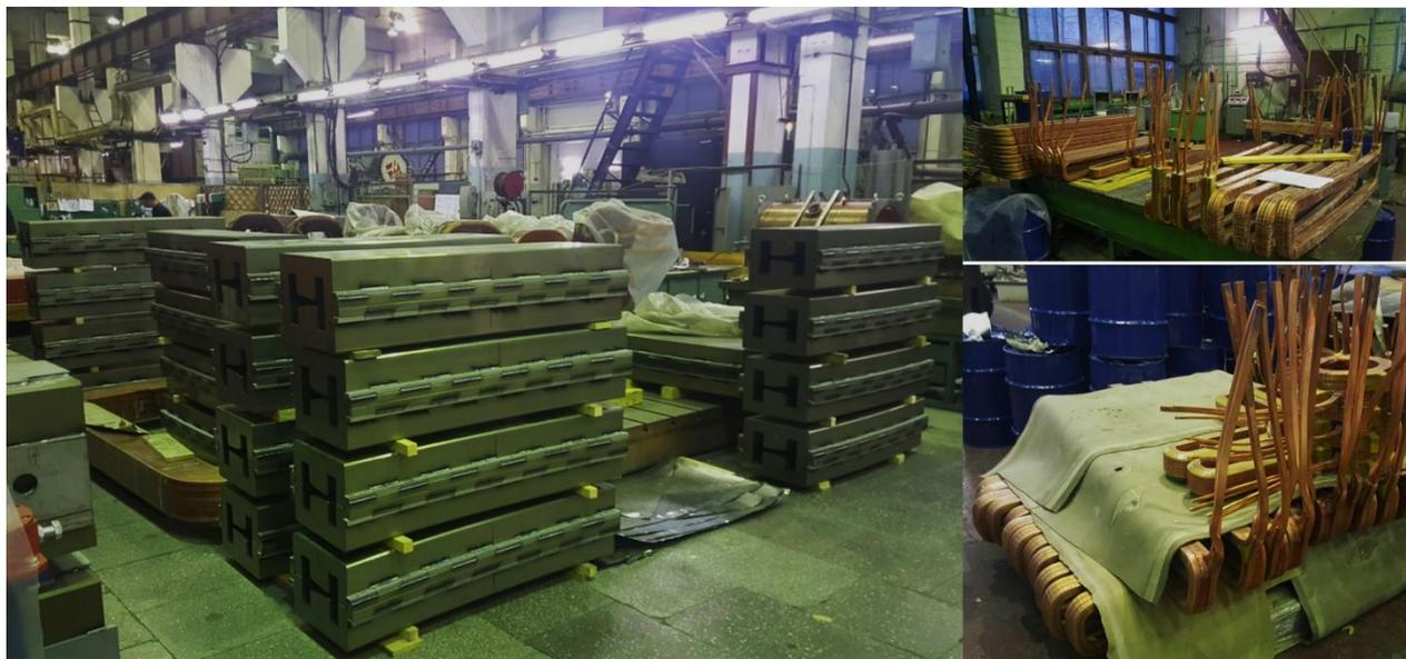
**Рисунок 3.** Готовые магнитопроводы и катушки диполей ВF и ВD бустерного синхротрона ЦКП «СКИФ» на складе экспериментального производства ИЯФ СО РАН.
