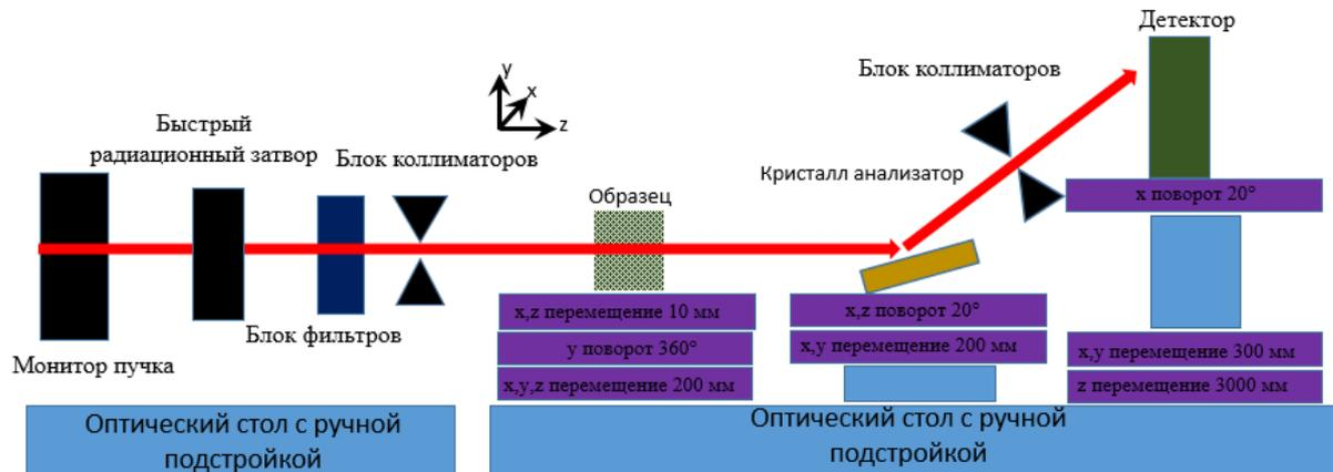
**Рисунок 22.** Схема секции «Рентгеновской микроскопии и томографии».
