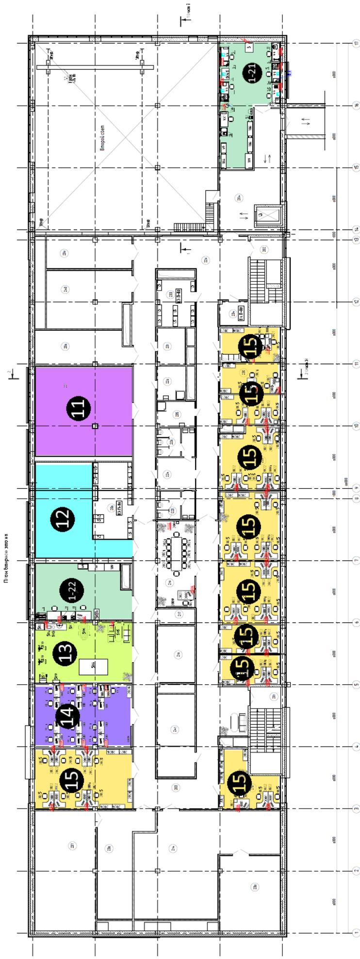
**Рисунок 3.** Эскиз планировки 2-го этажа. 1-21 и 1-22 – участок механической обработки и проболоподготовки, 11 – участок томографии, 12 – участок термического анализа, 13 – комната отдыха, 14 – терминальный класс, 15 – офисы.
