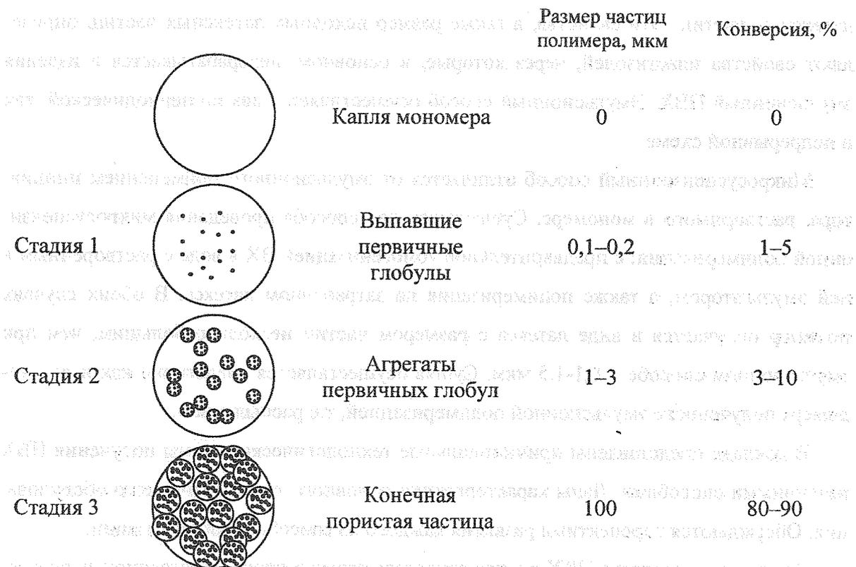
Рис. Схема образования частицы ПВХ при суспензионной полимеризации.
