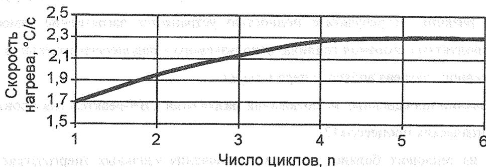
Рисунок 2. Зависимость скорости нагрева катализатора К-16у от числа циклов
