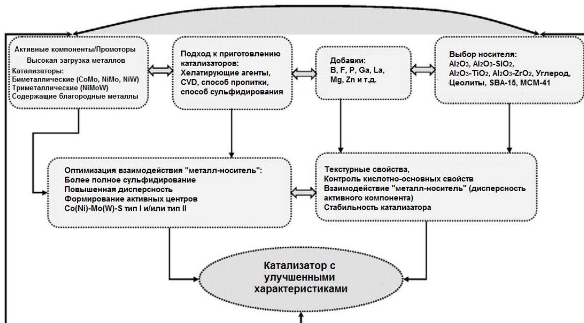
Рис. 10. Подходы к приготовлению катализаторов гидроочистки с повышенной активностью (адаптировано из [26]).
