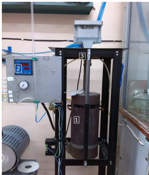
Рис. 11. Установка для синтеза и модификации углеродных носителей: 1. Вертикальная печь с возможностью нагрева до 950^\circ\text{C} ; 2. Блок регулировки температуры и скорости нагрева (Термодат); 3. Газовая линия.
