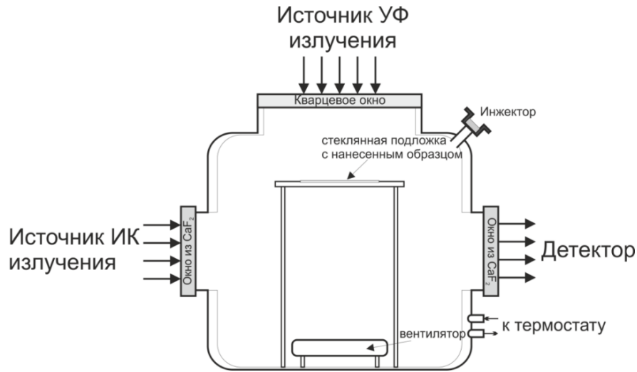
Рис. 20. Схема статического реактора используемого при исследовании процессов фотокаталитического окисления паров органических веществ методом ИК in situ .
