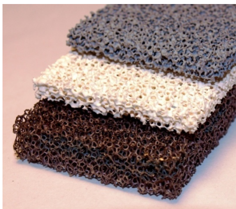
Рисунок 2.1. Фотография пеноносителей, использованных для приготовления структурированных каталитических систем.
